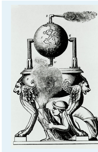
FIGURA I.5. Turbina de Herón movida con vapor de agua generada con el calor del fuego. Farey, John. (1827).
