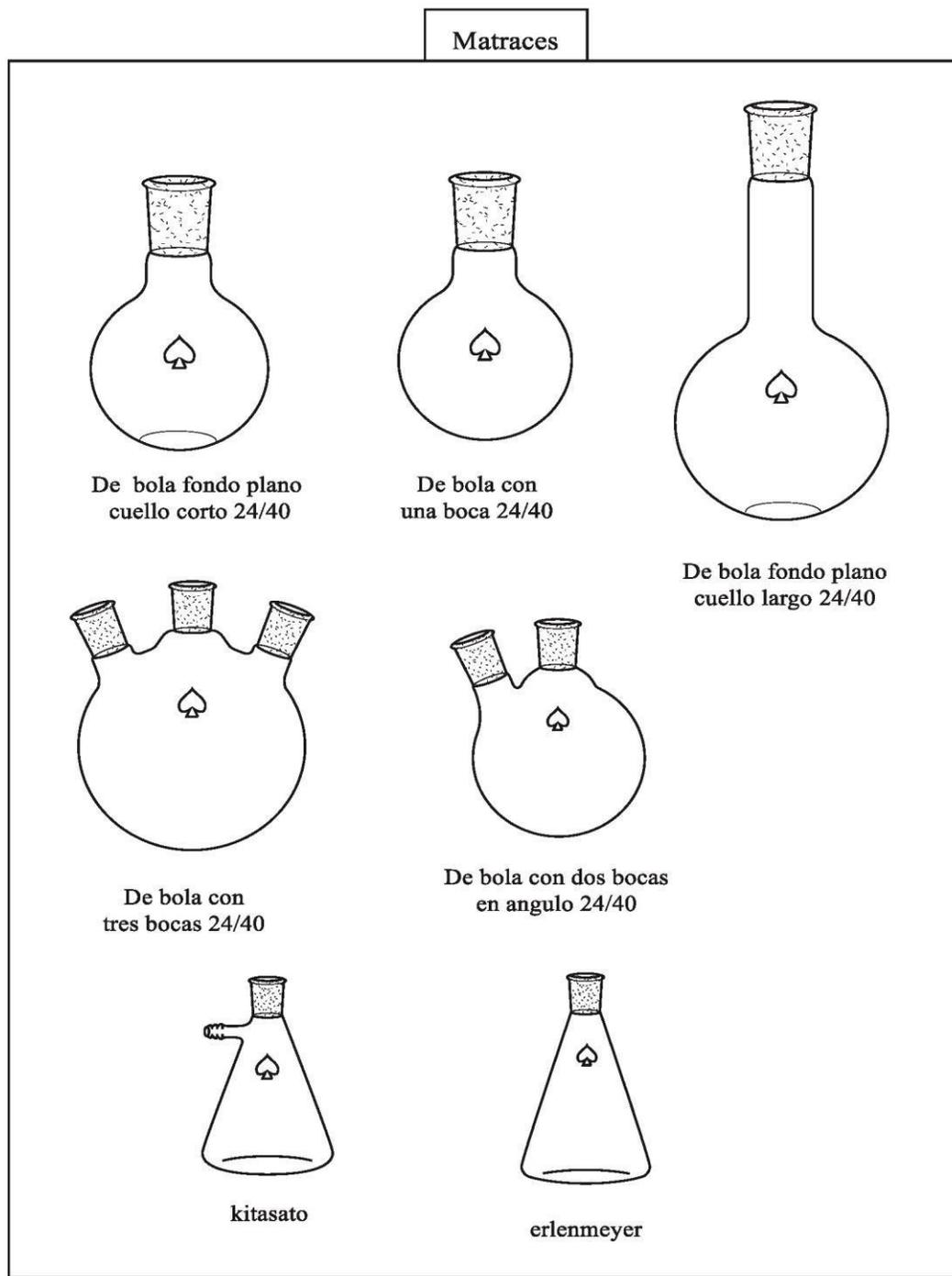
**FIGURA 4.** Tipos de Matraces (Elaborados con el software ChemBioDraw Ultra 14.0).
