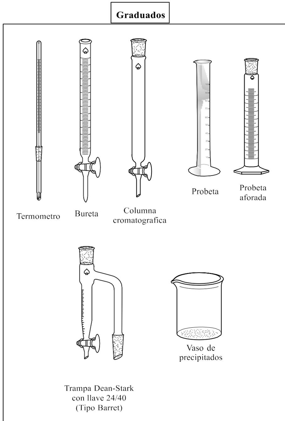
**FIGURA 9.** Tipos de material graduado (Elaborados con el software ChemBioDraw Ultra 14.0).
