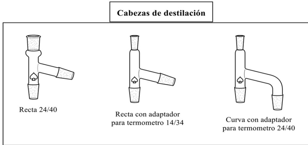
**FIGURA 7.** Tipos de cabezas de destilación (Elaborados con el software ChemBioDraw Ultra 14.0).
