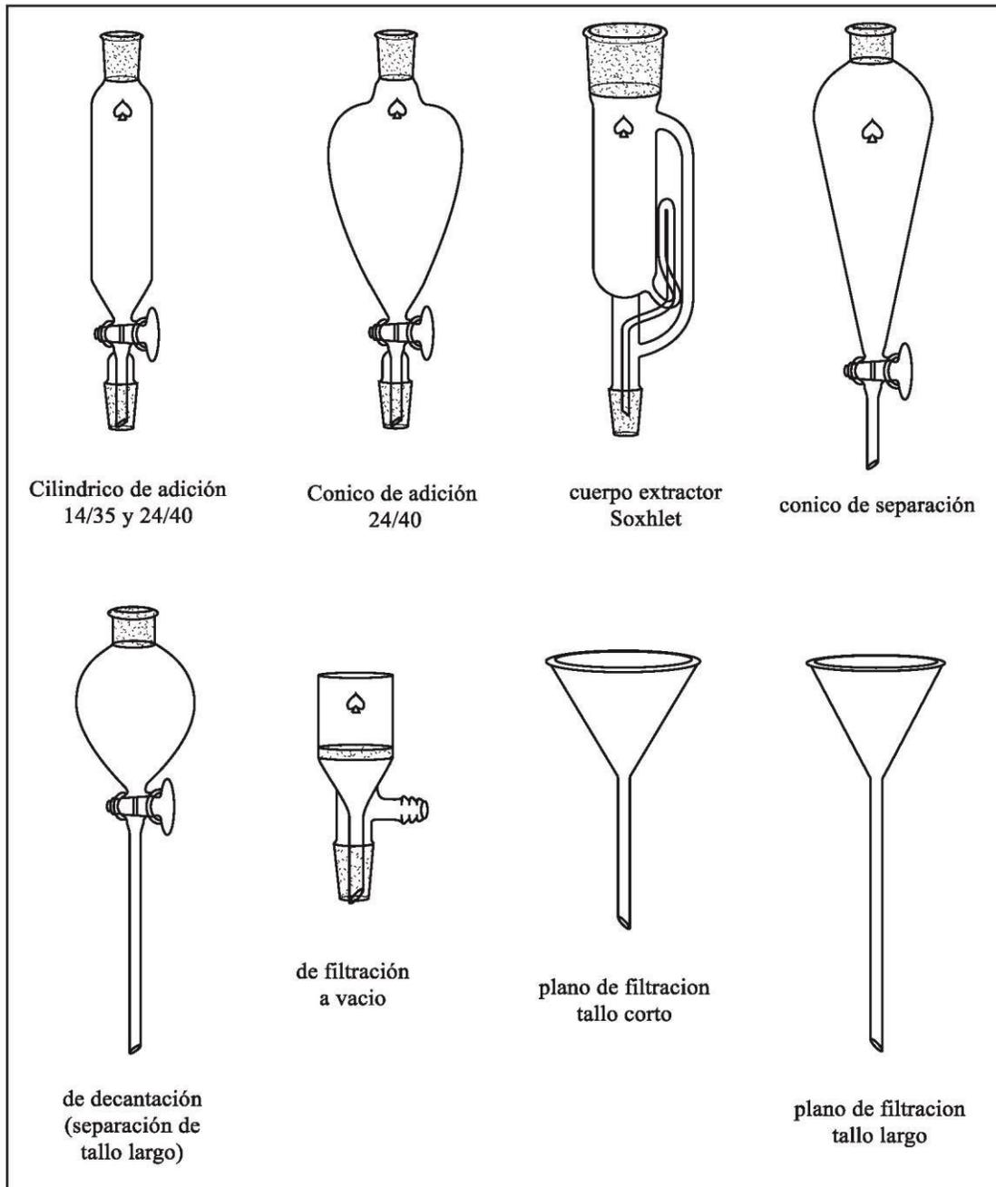
**FIGURA 5.** Tipos de embudos (Elaborados con el software ChemBioDraw Ultra 14.0).
