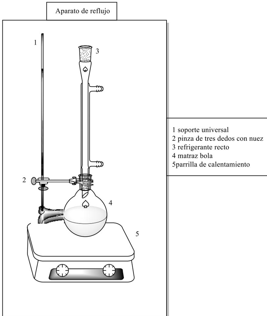
**FIGURA 15.** Aparato de reflujo (Elaborados con el software ChemBioDraw Ultra 14.0).
