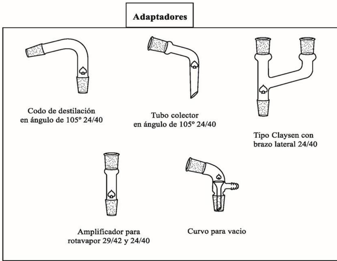
**FIGURA 8.** Tipos de adaptadores (Elaborados con el software ChemBioDraw Ultra 14.0).
