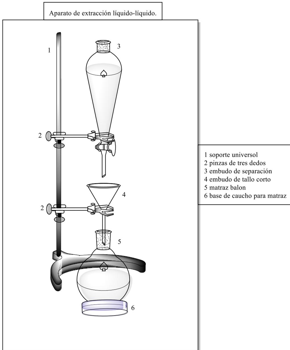
**FIGURA 14.** Aparato de extracción líquido-líquido (Elaborados con el software ChemBioDraw Ultra 14.0).
