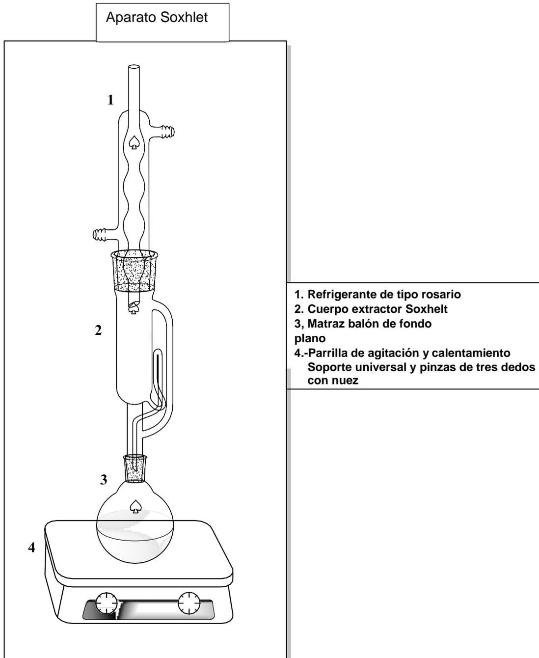
**FIGURA 11.** Aparato Soxhlet (Elaborados con el software ChemBioDraw Ultra 14.0).
