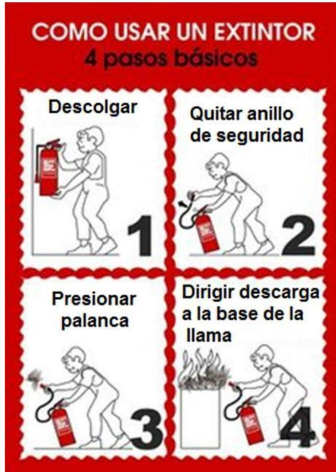
**FIGURA 3.** Manejo del extintor
