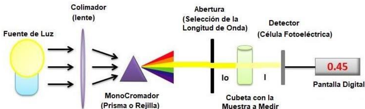
Figura 1. Funcionamiento del espectrofotómetro
