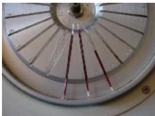
Figura D colocación de los capilares en la centrifuga
