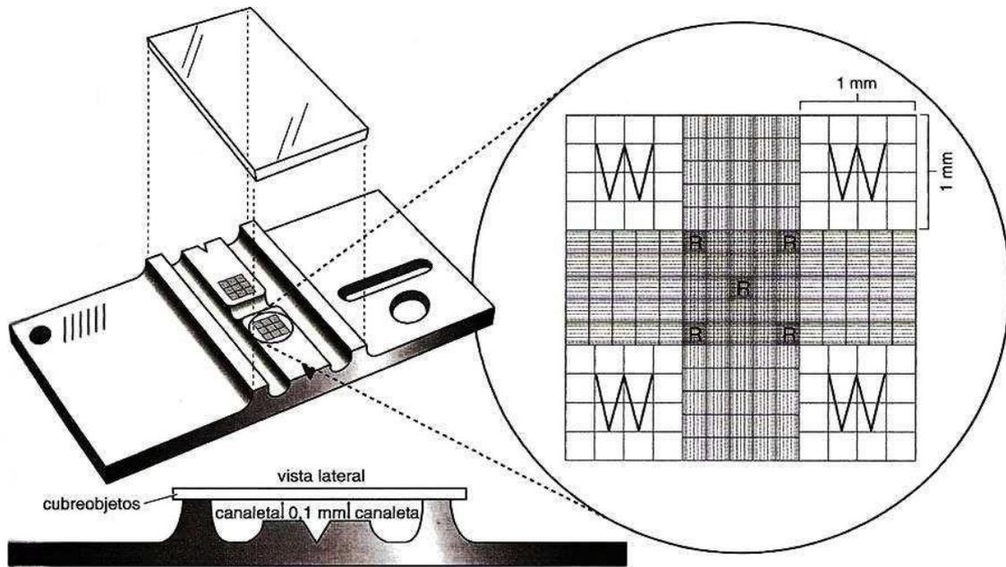
**Fig. No. 10.** Cámara de Neubauer y un primer plano de las áreas de conteo como se ven en el microscopio. Los cuadros marcados con una W se emplean para contar leucocitos y los que están marcados con una R para eritrocitos.
