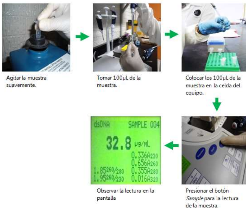
Fig. 6 Pasos a seguir para medir la concentración de una muestra.
