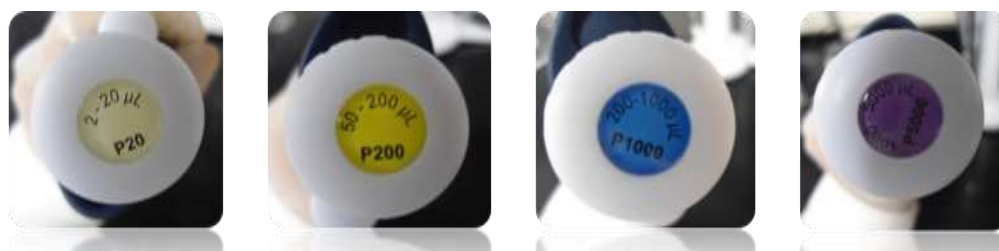
Fig. 2. Imágenes de pipetas de la marca Gilson de distintas capacidades.
