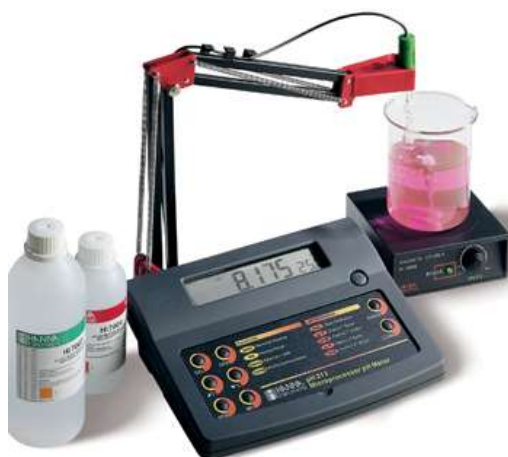
Fig. 4. Potenciómetro HANNA HI 223®
