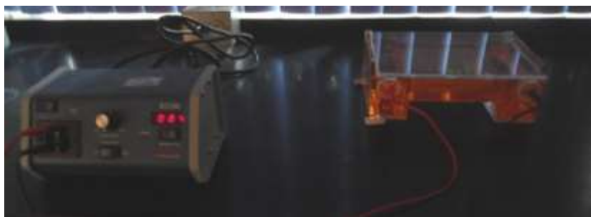
Fig. 9. Conexión de la cámara a la fuente de poder.
