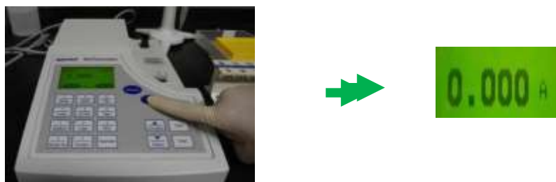
Fig. 5 Ajuste del equipo a cero de absorbancia
