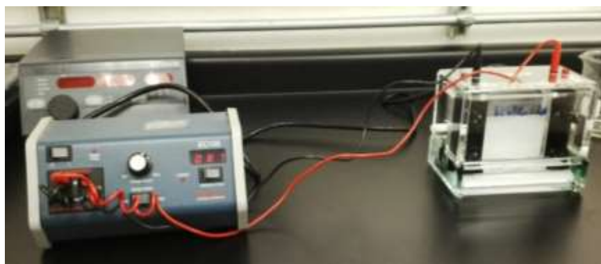
Fig. 19. Cámara de electroforesis conectada a la fuente de poder.
