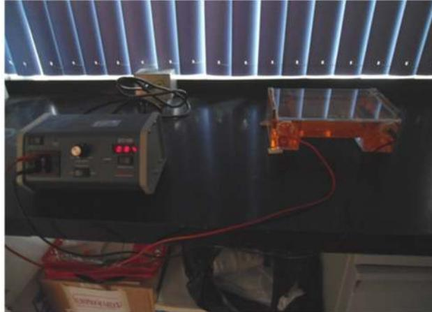
Fig. 9. Conexión de la cámara a la fuente de poder
