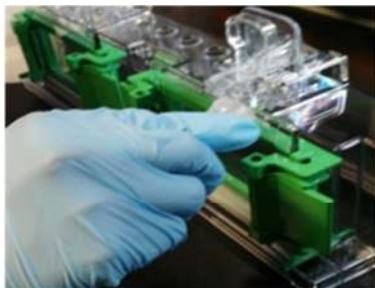
Fig. 21. Adición del gel concentrador.
