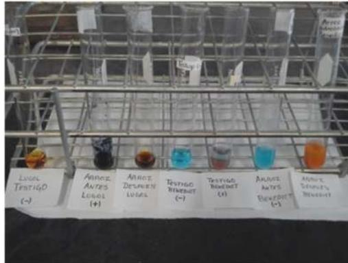
Fig. 6. Resultados de las pruebas de Lugol y Benedict para almidón antes y después de la hidrólisis.
