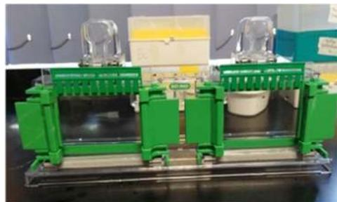
Fig. 22. Colocación de peine para la formación de los pocillos.
