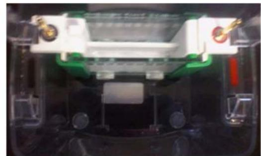
Fig. 26. Ensamble dentro de tanque.
