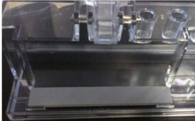
Fig. 11 Soporte de polimerización con banda de goma.
