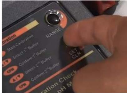
Fig.7C. Inicio de calibración.
