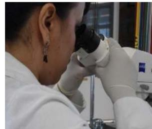
7. Moviendo el tornillo macrométrico, hacer descender lentamente la platina hasta que se vea, mirando por los oculares, la imagen de la muestra. Cuando se use el objetivo de inmersión, nunca debe separarse de la preparación como para perder el contacto con el aceite.
