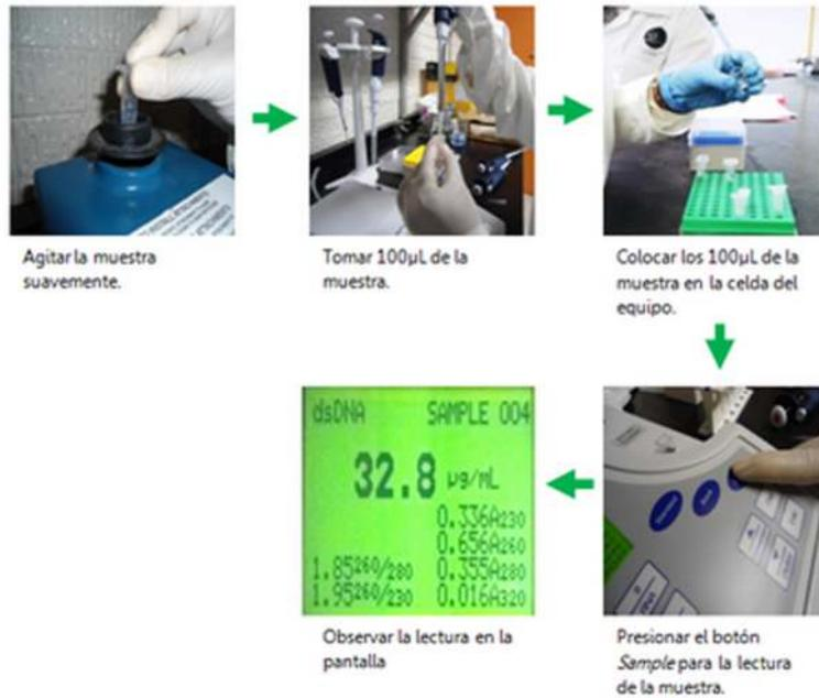
Fig. 6. Pasos a seguir para medir la concentración y pureza de una muestra.
