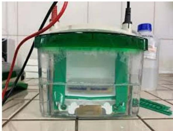
Fig. 7. Gel SDS-PAGE al final de la migración, se aprecia el frente de migración pero no las proteínas.
