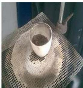
Fig. 3. Calcinación de muestra.
