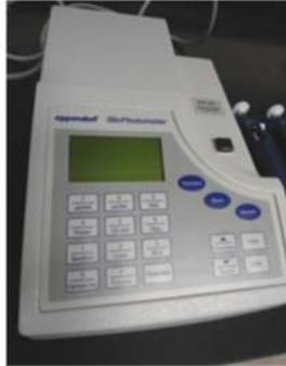
Fig. 4. Equipo Biofotómetro.
