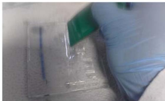
Fig. 32. Recuperación del gel de las placas.
