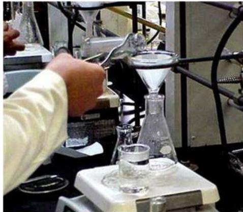
Fig.3. Filtración en caliente
