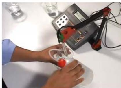
Fig.7E. Lavado del electrodo.
