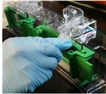
Fig. 17. Adición del gel separador en las placas.
