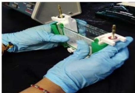
Fig. 25. Gel en ensamble de electrodos.
