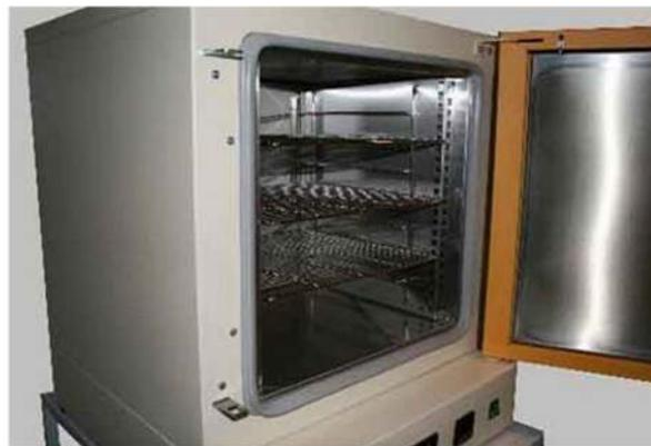
Fig. 4. Estufa para la activación de placas.
