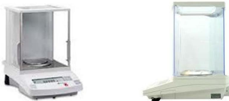
Fig. 1. Vista lateral y frontal de balanza analítica OHAUS®.
