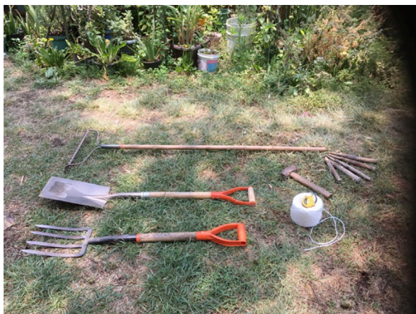
Figura 11. Rastrillo, pala recta, bieldo, cinta métrica, estacas, cuerda, martillo.
