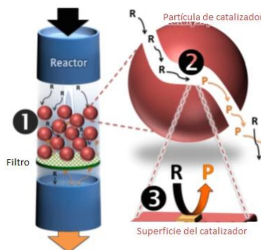
**Figura 1.** Reactor con catalizador heterogéneo, donde se muestra como se separan de las moléculas de reactivos (R) y productos (P), además de un acercamiento a la superficie y a la partícula del catalizador (Imagen tomada de la referencia 1).
