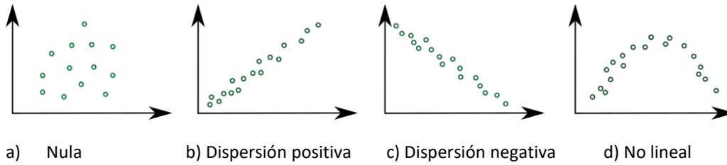
**Figura 14.24** Tipos de dispersiones en una gráfica de puntos
