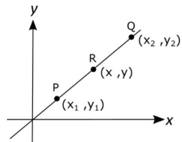
**Figura 7.5** Puntos P, Q y R con la misma pendiente.
