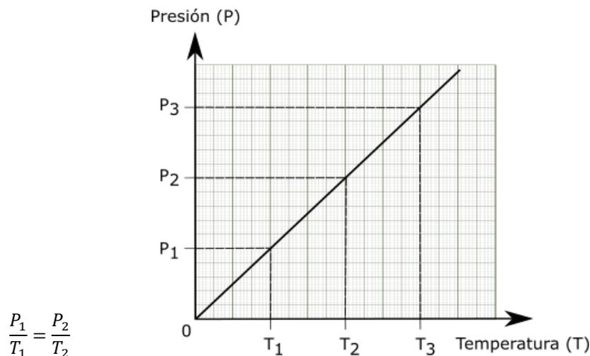
**Figura 3.5** Relación proporcional de la Presión y la Temperatura, representada por la ecuación de Guy-Lussac
