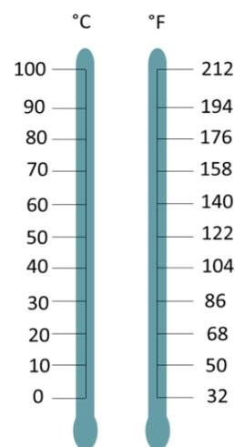
**Figura 3.2** Escalas comparativas de temperatura de Celsius y de Fahrenheit.
