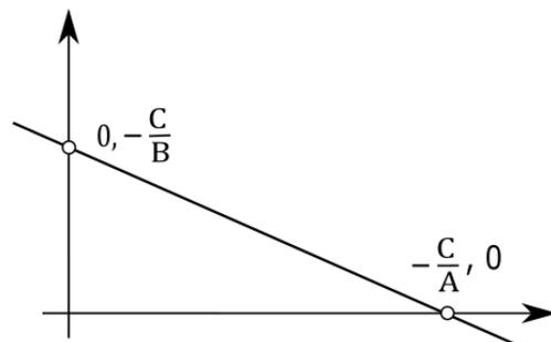
**Figura 7.6** Intersección de una línea recta con los ejes cartesianos.
