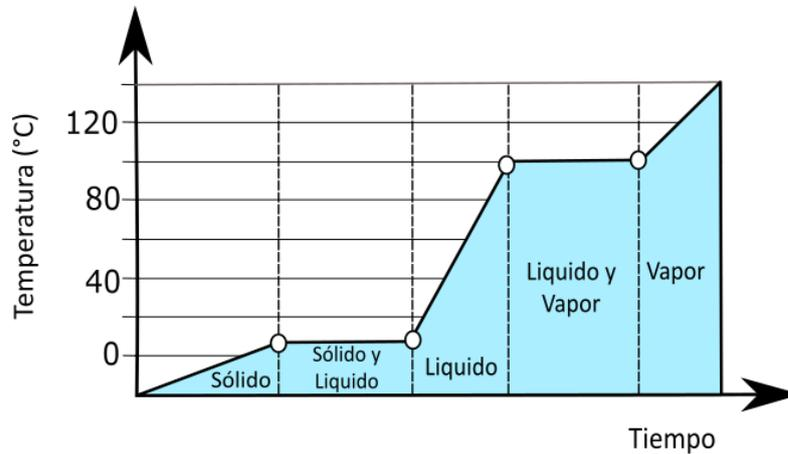
**Figura 14.10** Gráfico de área que representa la curva de calentamiento del agua a presión atmosférica
