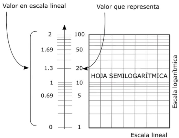
**Figura 11.4** Explicación de la escala no lineal de una hoja semilogarítmica
