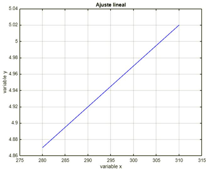
**FIGURA 18.** Ajuste polinomio lineal por Lagrange.
