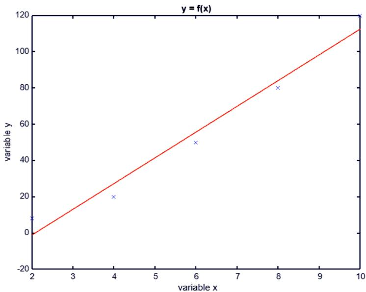
**FIGURA 14.** Ajuste lineal generado por el programa y por mínimos cuadrados.
