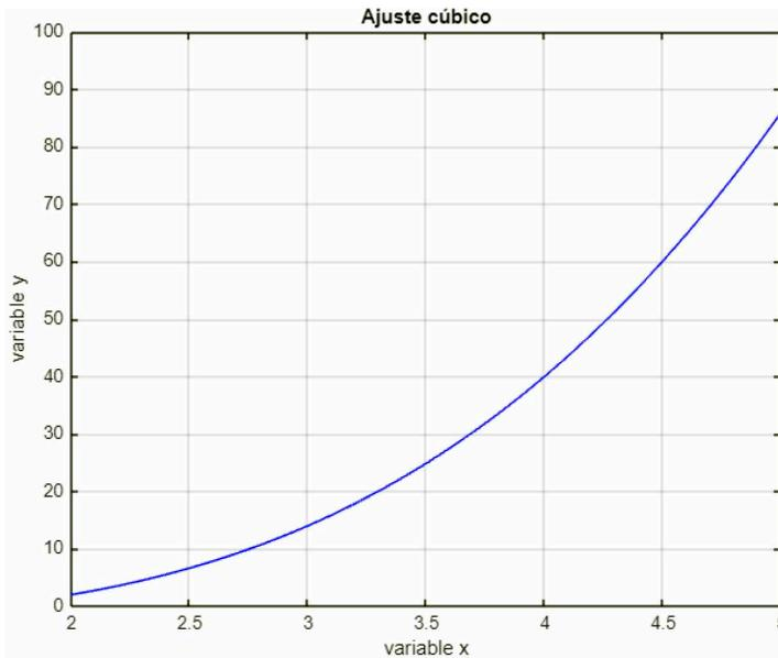
**FIGURA 19.** Ajuste polinomio cúbico Lagrange.
