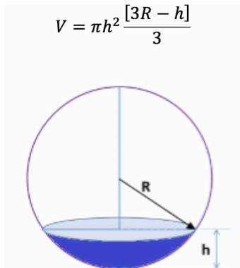
$R$  es el radio del tanque (ft), y  $h$  es la profundidad del agua en el tanque (ft).
