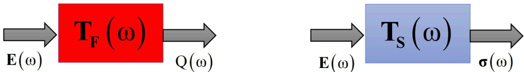
**Figura 6-1.** Función de transferencia del flujo volumétrico (izquierda), función de transferencia del esfuerzo cortante (derecha).
