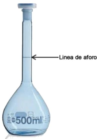
El matraz aforado se utiliza para preparar soluciones estándar o de concentración exacta y para diluir muestras. La tolerancia va de 0.02 a 0.5 mL según la capacidad del matraz, a mayor volumen mayor tolerancia.
