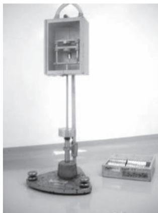
**Figura 1** Equipo determinador de resistencia a la dureza para supositorios.
