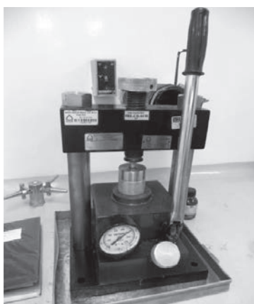
Figura 2 Prensa hidráulica para comprimir el fármaco de prueba.
