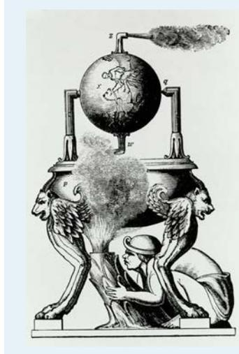
**FIGURA I.5.** Turbina de Herón movida con vapor de agua generada con el calor del fuego. Farey, John. (1827).
